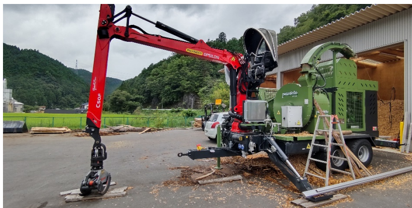
西栗倉村の土場で導入されているチップパー。ヨーロッパ製。
